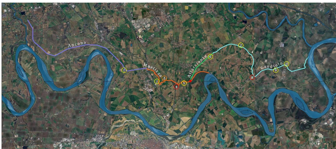
Figura 3 - Collettore Generale di Bonifica. Sono distinte le quattro tratte che lo costituiscono ed evidenziati gli impianti irrigui cerchiati in giallo e quelli idrovori di bonifica, cerchiati in rosso. L'impianto n. 3 di Resmina ha funzione promiscua. In ordine da ovest a est: 1-Irriguo Chierichezze; 2-Irriguo Braglia; 3-Promiscuo Resmina; 4-Idrovoro di bonifica S. Rocco; 5-Irriguo Mezzana Casati; 6-Irriguo Mezzano Vecchio; 7-Irriguo Cancelliera; 8-Idrovoro di bonifica Rottino; 9-Irriguo S. Antonio; 10-Irriguo Bondiocca. Col rombo rosso è contrassegnato, infine, il Chiavicone.
